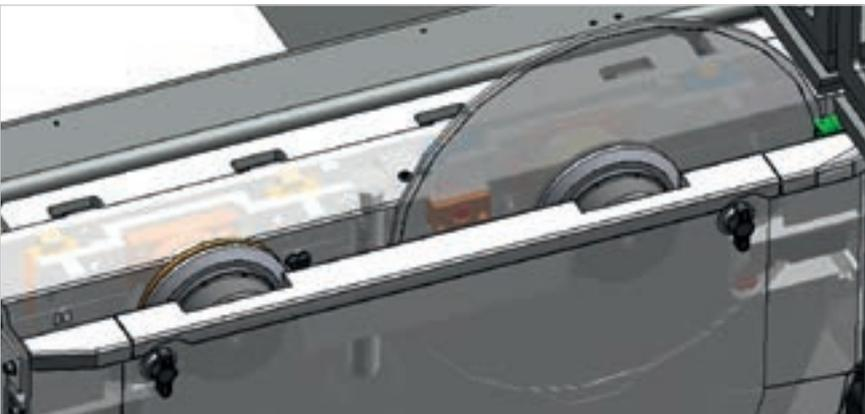
防滑装置用以控制锯片的位置和转数，调整前进速度。该设备可取得最好的切割质量，可延长锯片的使用寿命，并降低设备的维护成本。
