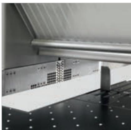
由于侧边规方靠挡与锯座融为一体，该设备可精确对齐超薄板材和/或柔性板材，最大限度地缩短循环时间。
